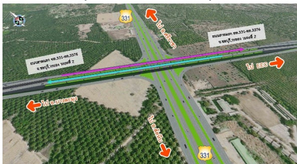
รูปที่ 7-4 รูปแบบทางแยกต่างระดับ กม.ที่ 4+444 ตัดกับทางหลวงแผ่นดินหมายเลข 331 (บริเวณ กม.ที่ 16+750)
