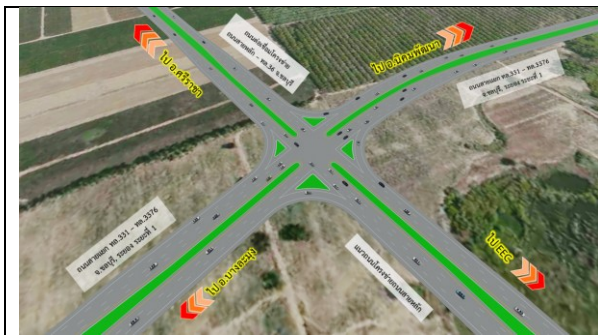
รูปที่ 9-2 รูปแบบทางแยกจุดเริ่มต้นโครงการ กม.ที่ 0+000 เชื่อมกับถนนสายแยก ทล.331 - ทล.3376 จ.ชลบุรี, ระยอง ระยะที่ 1 (บริเวณ กม.ที่ 3+477)
