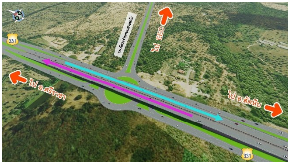
รูปที่ 8-2 รูปแบบทางแยกต่างระดับ จุดเริ่มต้นโครงการ กม.ที่ 0+000 เชื่อมกับทางหลวงแผ่นดินหมายเลข 331 (บริเวณ กม.ที่ 12+068)
